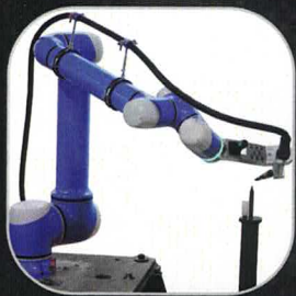
Kobotické rameno s hořákem
