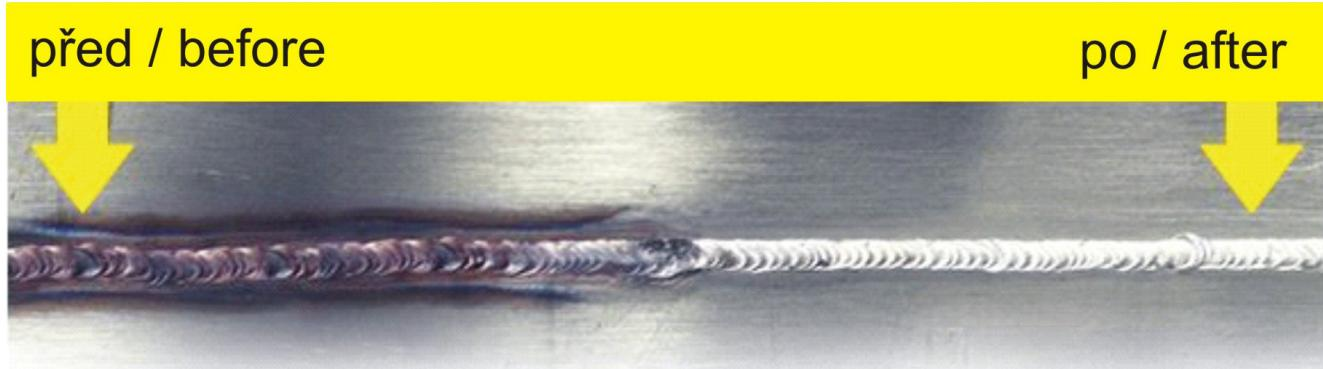
Systém Clinox, prostřednictvím okamžité elektrochemické reakce, zajišťuje čištění, pasivaci a leštění každého svaru z nerezové oceli a to bez ohledu na úpravu. Samotný proces je velmi rychlý a to aniž by ovlivnil okolní materiál a zcela bezpečný pro provozovatele.
