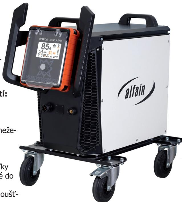
SVAROG 85 PLASMA SYN je vybaven proporcionální ventilem, který umožní přesné nastavení požadovaného pracovního tlaku plynu a zobrazení hodnoty tlaku na displeji. Proporční ventil umožňuje přesně nastavit potřebný tlak, respektive průtok plynu a umožní vysokou přesnost řezání.
