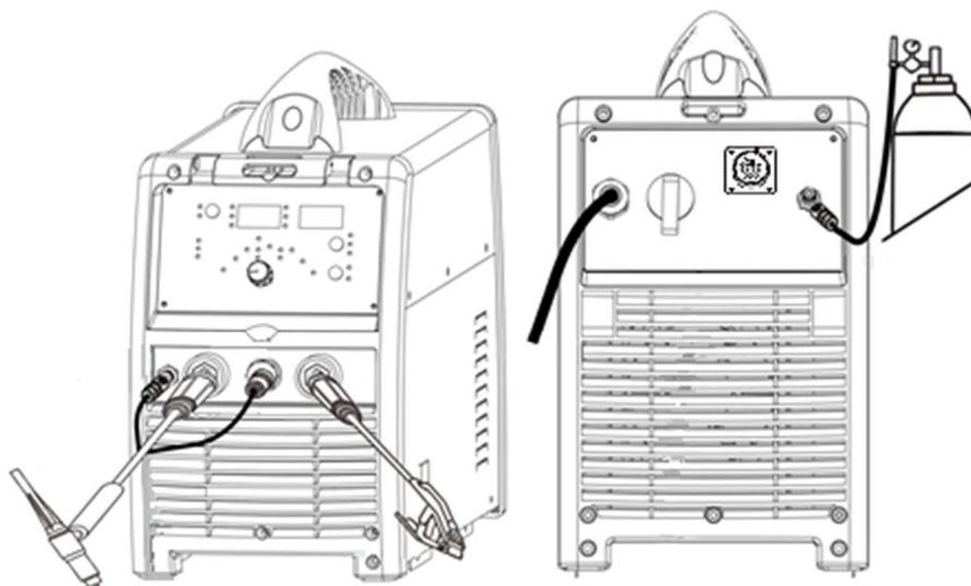
Obr. 7 - Zapojení hořáku chlazeného plynem
