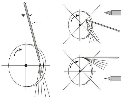
Obr. 11 - Broušení W elektrody, vlevo správně, vpravo špatně
