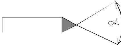
Obr. 10 - Úhel broušení konce W el.
