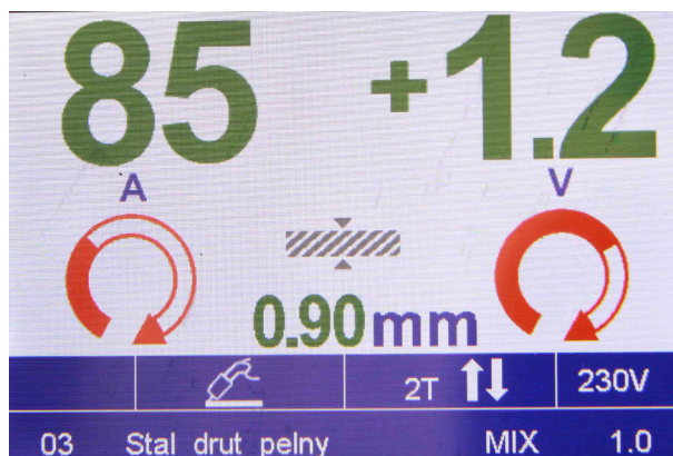
Rysunek 6: Ustawienie parametrów spawania (wybrano program 03, natężenie 85 A, korekta długości łuku +1,2)
