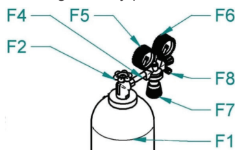
Rysunek 14: Ustawienia przepływu gazu osłonowego.
