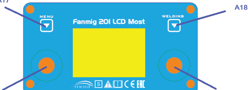
Rysunek 2: Panel sterowania FANMIG 201 LCD
