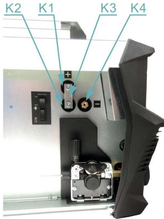
Abb 13. Detail der Anschlüsse der Änderung der Polarität des MIG/MAG-Brenners
