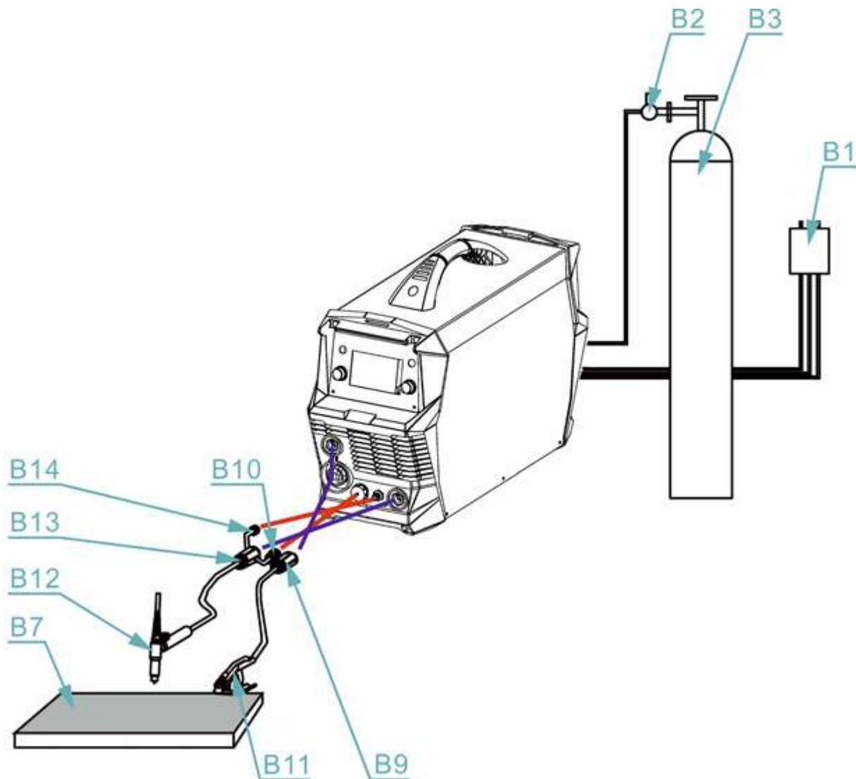
Abb 15. Anschluss der Hauptkomponenten WIG
