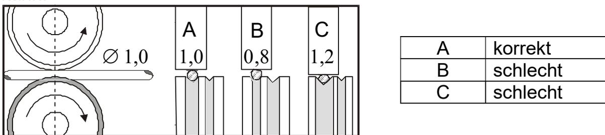
Abb 9. Der Einfluss der Drahtvorschubrolle auf den Schweißdraht
