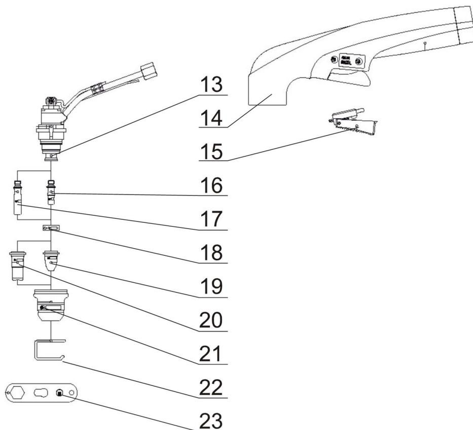
Obr. 2b. Hořák BINZEL ABICUT 45 – spotřební díly
