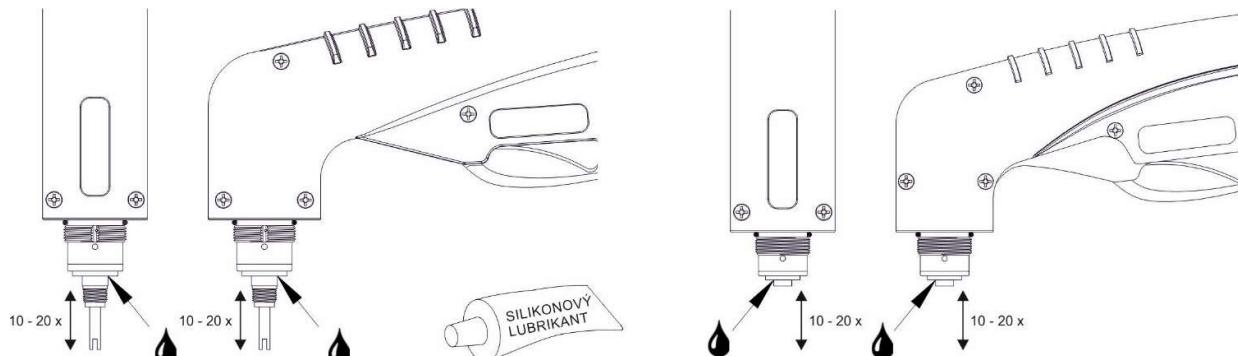
Obrázek 10. Mazání držáku elektrod
