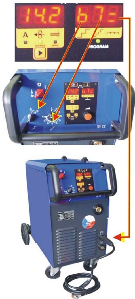
Rysunek nr 5 – wskazania parametrów synergicznych na wyświetlaczu (inny model Fanmiga)
