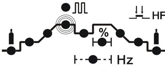
automatisch den Wechsel an. Nach jeder Parameteränderung schaltet die Maschine bei Inaktivität des Encoders nach 3 Sekunden automatisch auf Hauptschweißstrom um.
