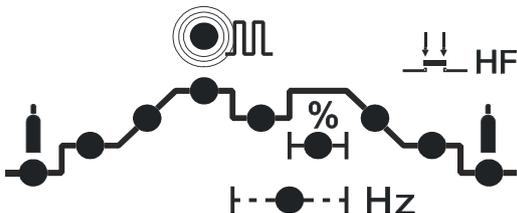
3. Betätigen Sie Schalter 21 und LED 14 beginnt zu blinken. Bei der dritten Betätigung des Schalters 21 aktivieren sie den Impulsmodus. Auf Display 13 erscheint „ON“. Die Funktion wird automatisch gespeichert und die LED 25 – Hauptschweißstrom leuchtet. Um den PULSE auszuschalten wählen Sie „OFF“.
