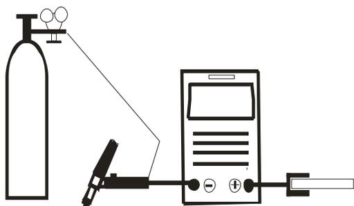
Den WIG-Schweißbrenner an die negative Buchse 5 anschließen.
