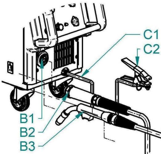
Abb.14 - Brenneranschluss
