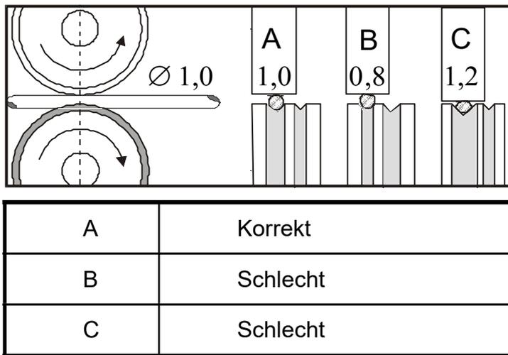
Abb. 11 – Der Einfluss der Drahtvorschubrolle auf den Schweißdraht
