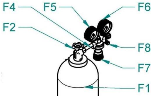
La saldatura deve essere fatta sotto la protezione del gas. La quantità di gas, però, non deve essere poca, in quanto non garantirebbe la protezione dall'atmosfera, ma neanche troppa, con conseguente apporto di aria all'interno dell'arco elettrico.
